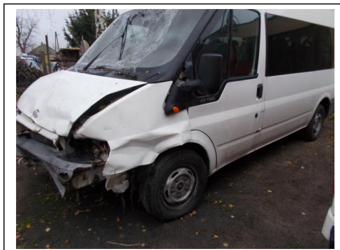
Fot.14. Uszkodzony przód strona L
